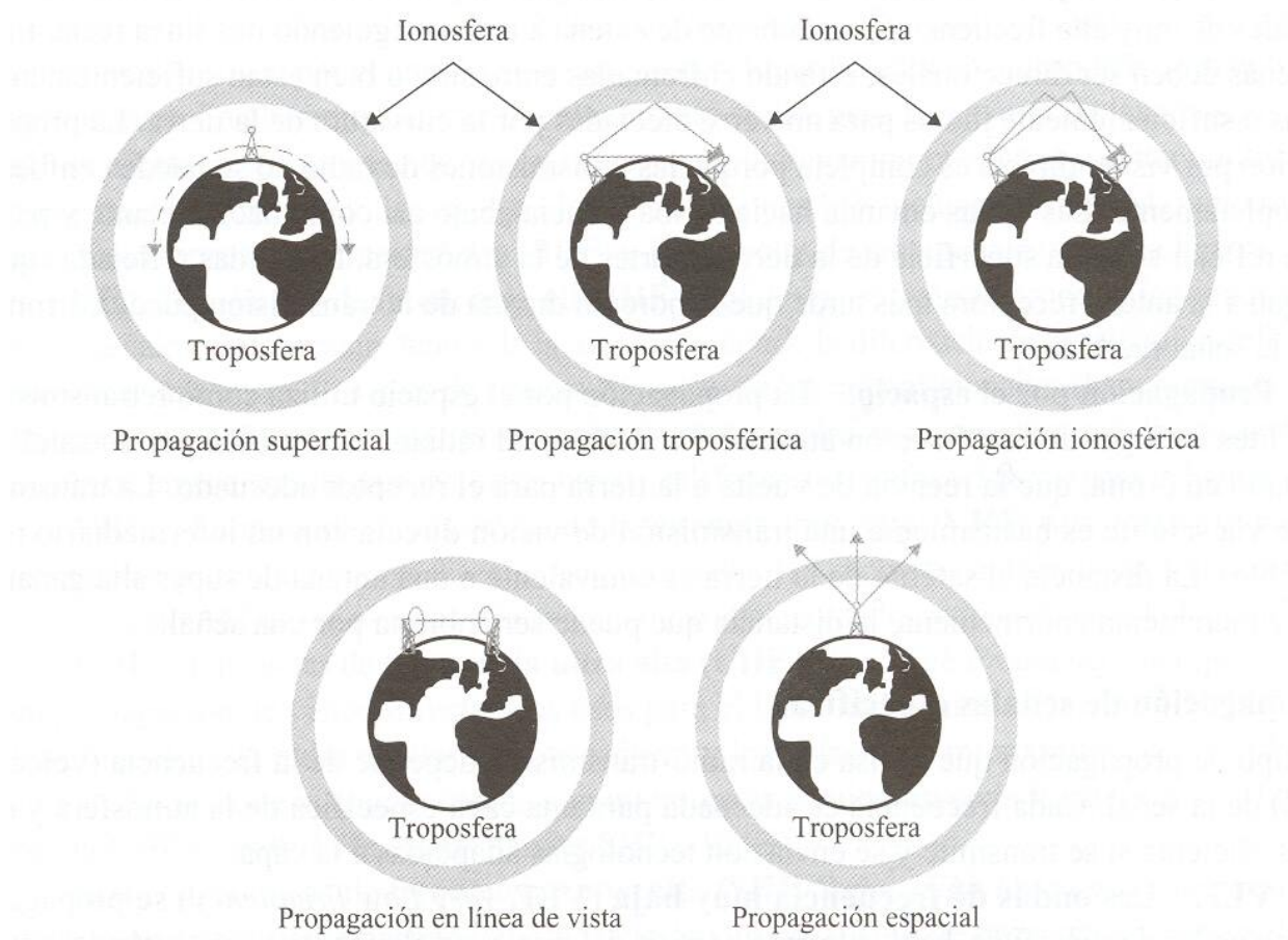
Figura 4-8. Modos de propagación de las ondas electromagnéticas.
